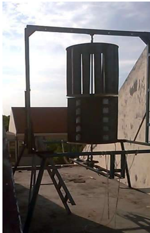
Gambar 11. Instalasi Prototipe turbin angin dengan bilah hybrid
